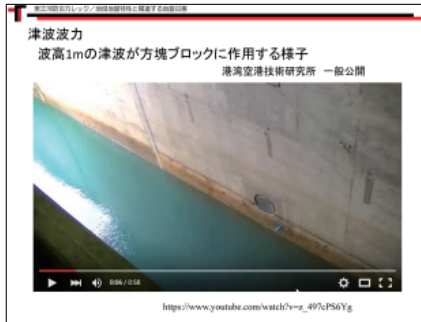
東日本太平洋沖地震で津波の威力は重々承知かと存じますが、こちらは波高1mの津波がブロックに作用する様子を示しており、非常にインパクトが大きいです。例えば、50cmの津波浸水深さが人間に作用した場合、人は立っていることが出来ません
