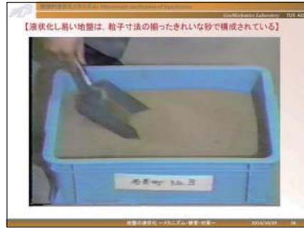
この動画は、液状化した地盤の土と液状化しなかった地盤の土の特徴を明らかにしています。液状化現象の危険度が高い地盤は粒子寸法の揃ったきれいな砂で構成されていることが理解できます。
