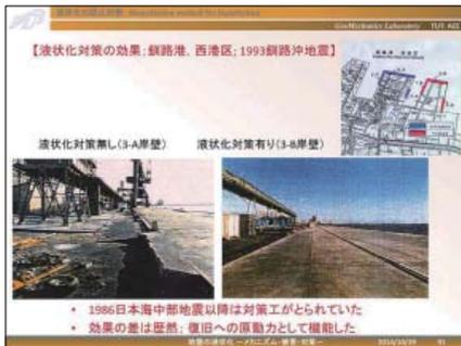
釧路沖地震で見られた釧路港岸壁における液状化対策の効果です。地盤条件や水深等も類似している隣接する埠頭においてです。液状化対策が取られていなかった古い埠頭では液状化により被害が発生し、荷役機械の機能が停止し、車両の移動にも制限が生じました。一方、日本海中部地震以降に建設された液状化対策を施した新しい埠頭では被害は軽微で、荷役機械の機能にも影響はほとんどありませんでした。
