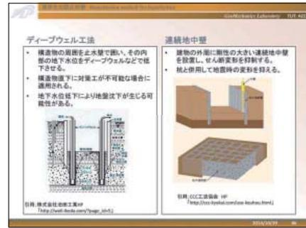
「ディープウェル工法」は地下水位を低下させることによって、液状化の発生条件を克服することを目指した工法です。既存の工法に対して適用されることがある工法です。地盤中に連続地中壁を建設する工法は変形(振動)を抑制することにより液状化の危険度を低下させ、液状化する場合でも地盤の流動化や水平変位を防止できることを目指した工法です。
