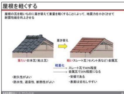
住宅は重ければ重いほど大きい地震力を受けます。これは、重量×地震動による速度＝建物に作用する水平力 となるためですが、逆に、重量が軽ければ軽いほど建物を受ける地震力は小さくなります。そのため耐震改修においては、屋根を粘土瓦で葺いている場合は、軽い瓦に葺き替えることで地震力を小さくすることも改修方法の一つです。屋根の軽量化により、耐震性能の向上あるいは必要とする壁量を少なくすることができます。
