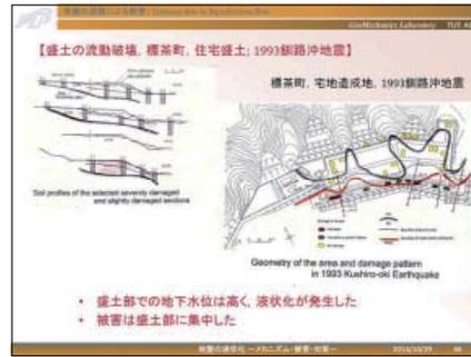
造成図の断面と平面図上にプロットした住宅の被災度を示しています。地盤調査で分かったように、盛土部では沢から流れ込んだ地下水が侵入して、比較的高い地下水位が保たれていました。また、被災した家屋のほとんどは盛土部に建設されたもので、切土部ではライフラインも含めて被害は軽微でした。盛土が液状化したために流動化し、側方流動しているのが観察されました。
