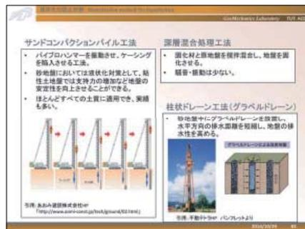
「地盤の密度増加する方法」は直接的で、効果の高い対策工法です。臨海部に埋立地を造成する場合には、振動と砂の圧入によって地盤の密度を増加させるサンドコンパクションバイブル工法が多用されます。
