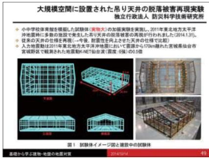
大規模空間に設置された吊り天井の脱落被害再現実験(独立行政法人 防災科学技術研究所)などが行われ、実際の天井の被害がどのように発生するかについて研究がなされています。これらの研究に基づいて安全な天井の設計法が提案されつつあります。
