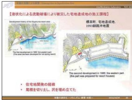
被災した住宅地の開発の歴史です。台地の外延部で沼地に面しているところでした。ここでは図示されているように切土と盛土によって平坦な宅地を造成したところで、通常の工法によって建設されました。盛土部は沢地を埋め立てて建設されています。
