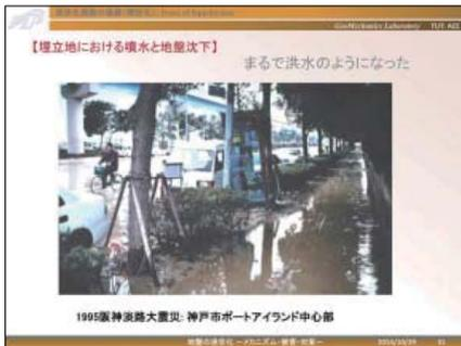
阪神淡路大震災ではポートアイランドで大規模な液状化が発生し、地表面には大量の地下水が噴出しました。直後はまるで洪水のような状況でした。
