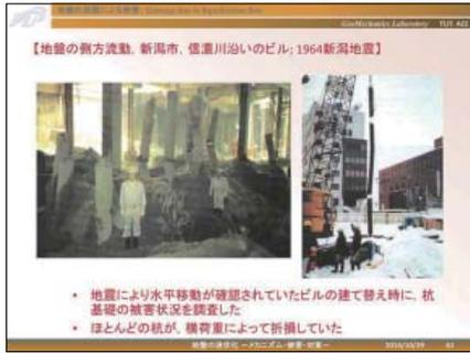
新潟地震では、ビルの基礎杭も被害を受けました。これは被災したビルをおよそ30年後に建てる際に基礎の調査をした時のものです。ビルは地震時に1m以上変位していることが確認されていました。このとき、杭には先端と杭頭が固定された条件で水平変位が生じたため、ほとんどの杭が2か所で曲げ破壊していました。
