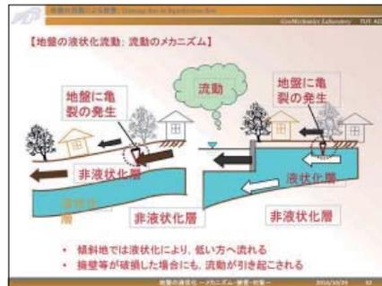
傾斜した地盤では液状化した地盤は低い方へ流れます。地盤が傾斜して入る水平な場合でも、河岸や海岸の護岸が土圧の増大によって変位すると、流動化した背後地盤が側方に流れます。
