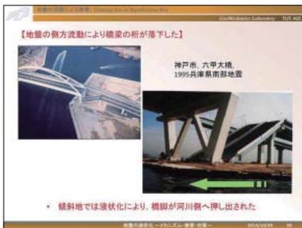
阪神淡路大震災では六甲大橋が被災して、橋桁が落ちました。これは橋脚付近の地盤が液状化して側方に変位したことが原因でした。
