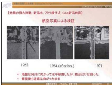
新潟地震前後の航空写真から万代橋橋台付近の地盤の側方変位の様子が観察できます。地震前には、河岸道路は左右に真っ直ぐ通っています。新潟地震では一部が信濃川に崩落するなど、大きな変位が観察されました。橋台には杭基礎が使われていたためその変位量はわずかでしたが、復旧した道路は大きく湾曲し、道路幅に相当する水平変位が生じていたことが分かります。
