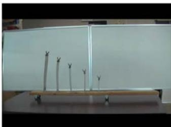
Vamos fazer uma maquete e simular um tremor. Na prática, quando simulamos um tremor vibrando rapidamente a construção baixa treme e quando simulamos tremor vibrando lentamente a construção alta treme. Por que tal fenômeno ocorre?
